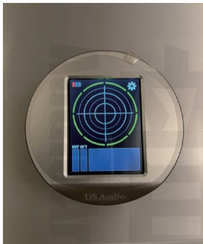
● 按下開關，顯示幕就會出現這樣的畫面，左邊電池紅色代表要更換電池了，右邊齒輪點進去可以做簡單設定。
