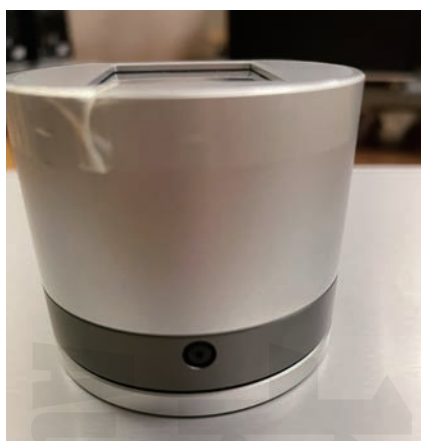
● ES-001的背面有一個螺絲，ES-001附有螺絲起子，拆開這個螺絲（不要轉到掉下來），就可以拿開上蓋外罩，更換電池。
